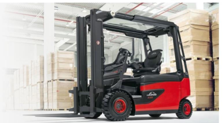
Die unverwechselbare Konstruktion der Linde Gegengewichtsstapler mit den obenliegenden Neigezylindern ermöglicht die einzigartige Rundumsicht der leistungsstarken und vielseitigen Linde Roadster E20 – E35 R
